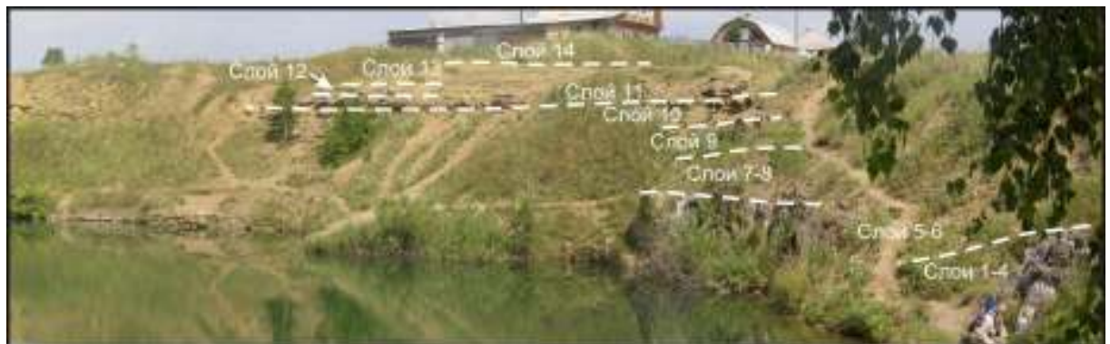
Рисунок 2.52 - Фотопанорама северо-восточного борта Лебедянского карьера. Пунктирными линиями обозначены границы слоев разреза E8211
